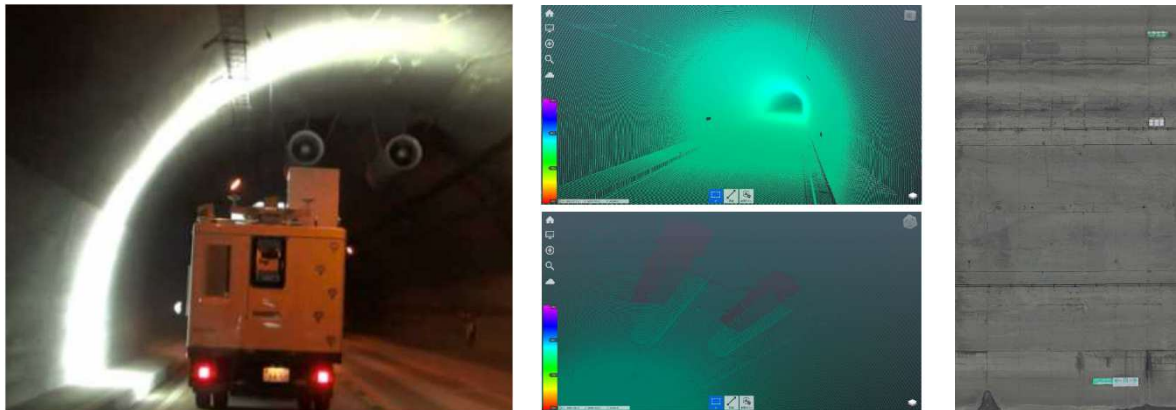
図 6 左から「走行型トンネル点検車両」「点群データ」「覆工画像」（大洲西トンネル）
