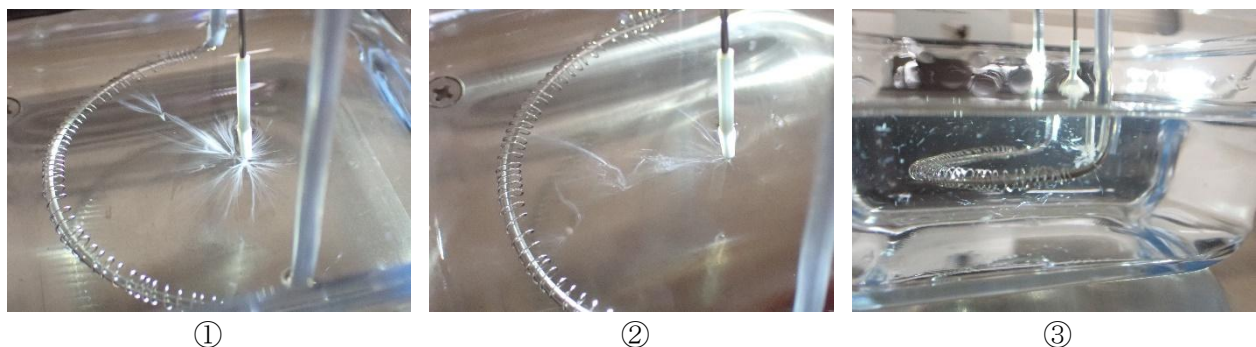
写真6 シート状繊維束の作製試験
