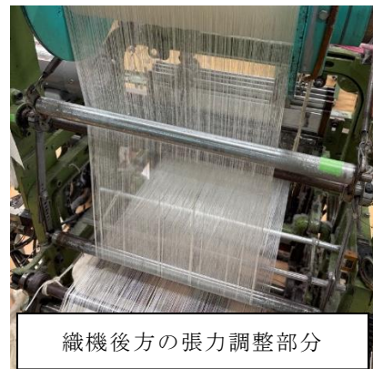
写真5 スナール指数4の糸での製織試験の様子
