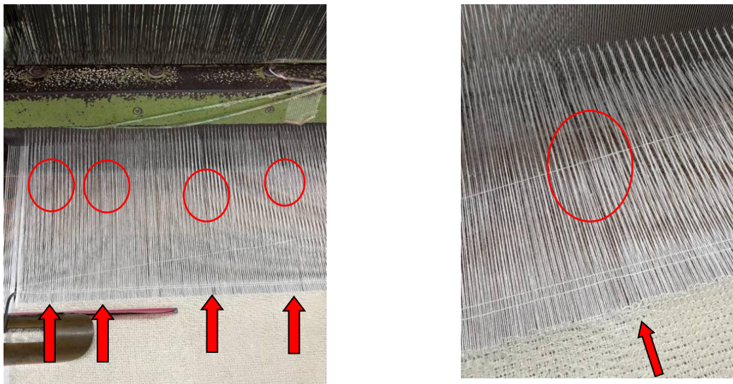
写真 3 スナール指数 5 の糸での製織試験の様子 (矢印部分は経糸の開きが悪い箇所)
