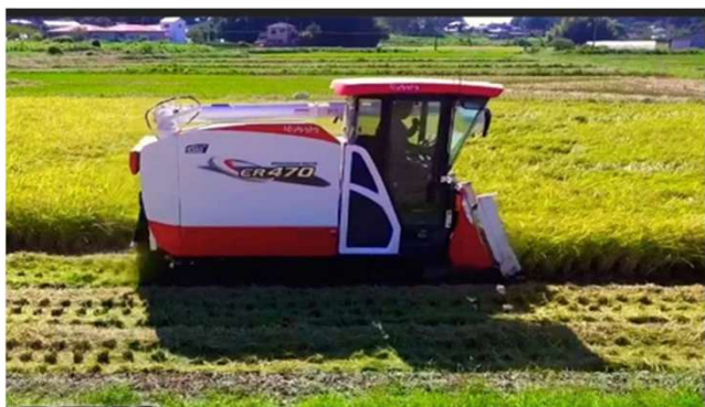
収量コンバインでは場1枚毎の収量データを取得
