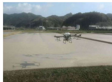
ドローンによる石膏資材 散布の実施
