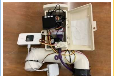
〔図14〕 製作した低コスト 環境計測機器
