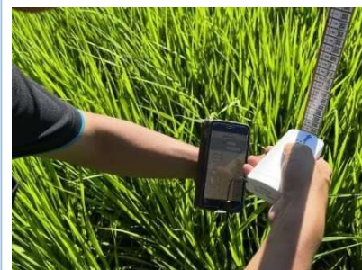
バーコードリーダーと二次元コード竹尺でデータを測定・保存
