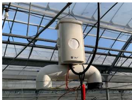
ハウスに設置した 低コスト環境計測機器
