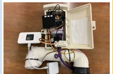
〔図14〕 製作した低コスト 環境計測機器
