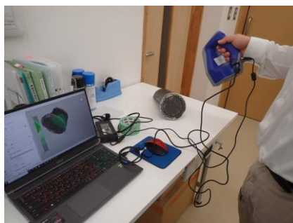
写真3 3次元データ取得工程
