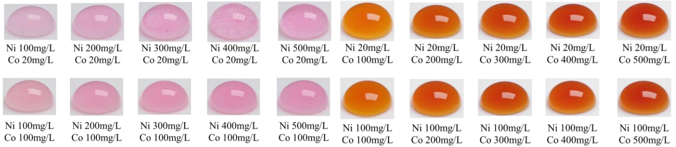
図 12 Ni 及び Co 発色液を用いた Ni、Co 混合液での発色結果 (左上) Co 濃度 20mg/L 固定、(右上) Ni 濃度 20mg/L 固定 (左下) Co 濃度 100mg/L 固定、(右下) Ni 濃度 100mg/L 固定
