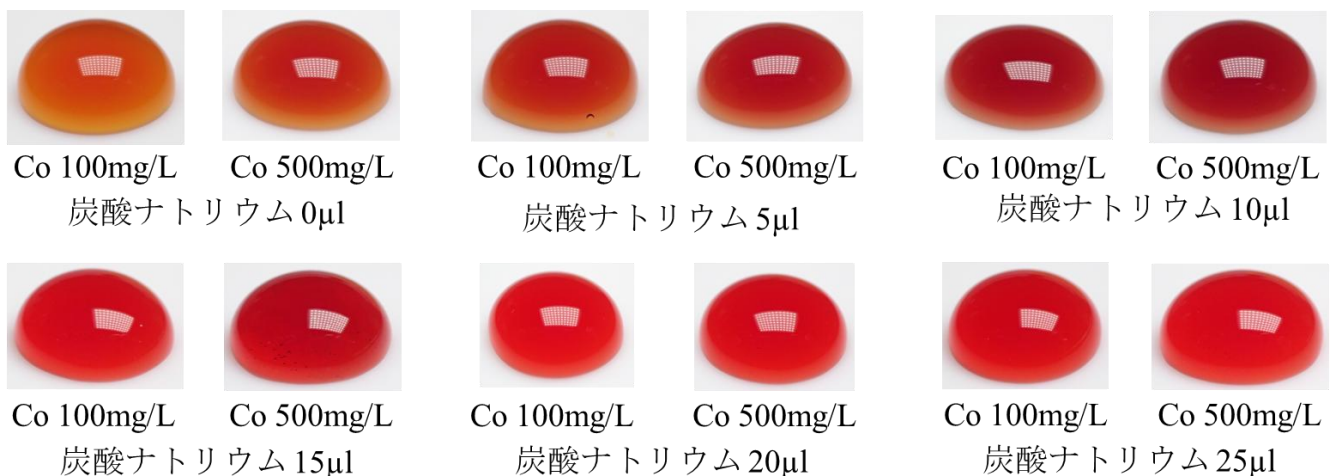
図3 Co 発色液の Co 発色に対する炭酸ナトリウム添加量の影響
