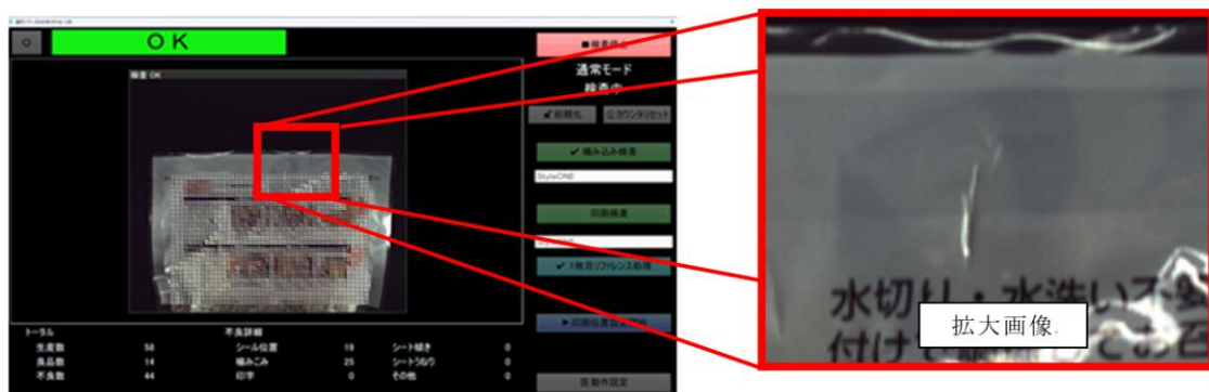
写真10 不良品を良品と誤判定した画像
