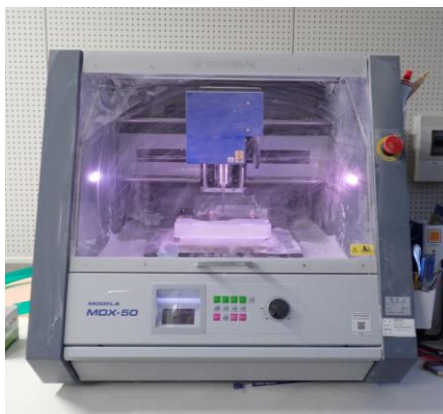
写真 1 モデリングマシンによる加工の様子
