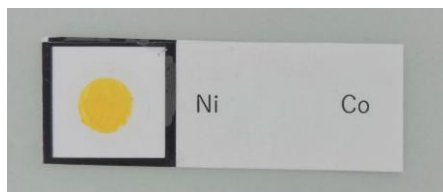
写真 1 試作した分析キット (Co 発色試薬を固定化)
