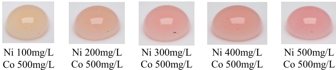
図6 Ni 発色液を用いた Ni、Co 混合液での発色結果
