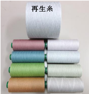
初回染色糸 再染色糸 写真3 再生綿糸の染色
