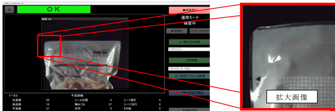
写真 12 不良品を OK と誤判定した画像
