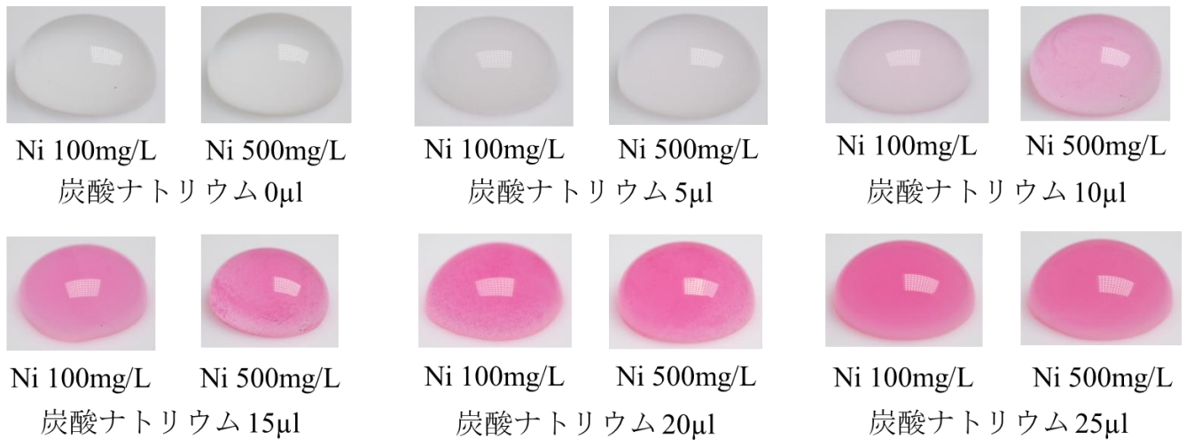
図2 Ni 発色液の Ni 発色に対する炭酸ナトリウム添加量の影響
