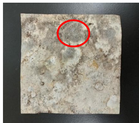
写真2 土壌生分解性試験4週間後のシート④の様子
