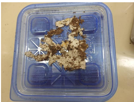
写真1 土壌生分解性試験2週間後のシートVの様子
