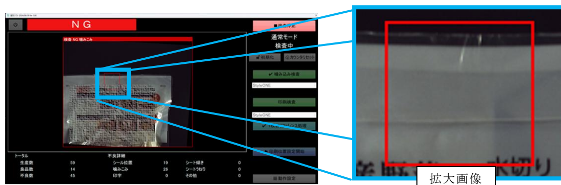
写真11 良品を不良品と誤判定した画像
