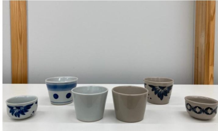
図6 試作品 (左：還元焼成 右：酸化焼成)
