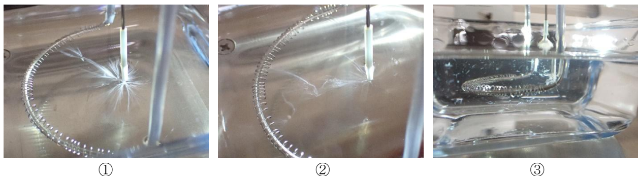
写真6 シート状繊維束の作製試験
