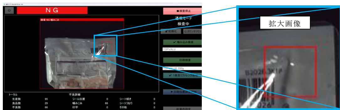
写真 13 良品を NG と誤判定した画像(下部の凹凸)
