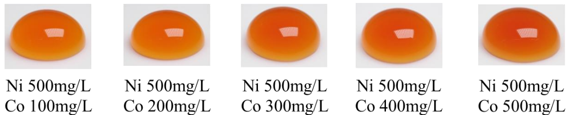
図7 Co 発色液を用いた Ni、Co 混合液での発色結果
