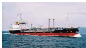
さゆり丸(ケミカルオイルタンカー)
