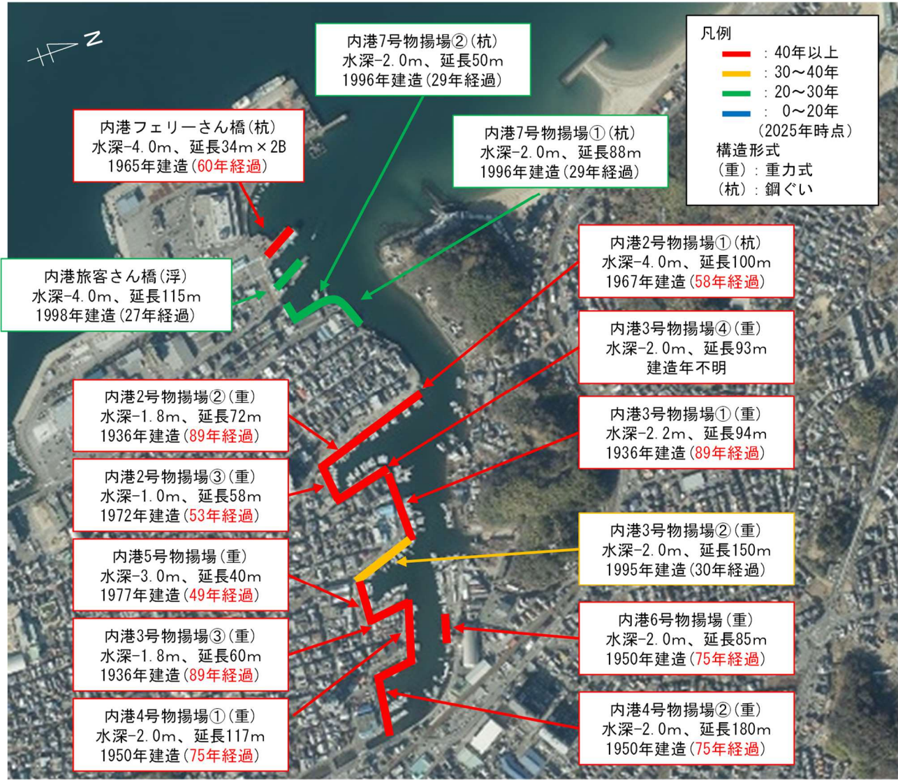
図 2.44 老朽化状況（内港地区）
