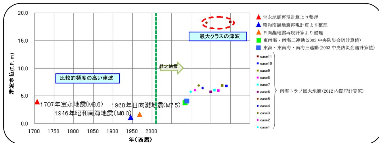
図ー3 最大クラス津波 (L2津波) の選定例
