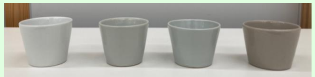
従来坏土 昨年度開発坏土 低温焼成坏土（還元焼成） 低温焼成坏土（酸化焼成）
