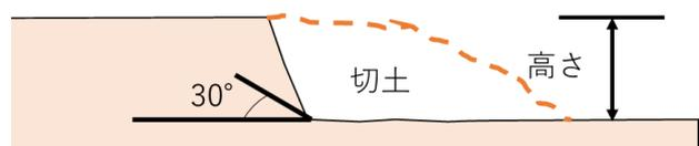
③盛土と切土を同時に行い、高さが **2m超** **5m超**の崖を生ずるもの（①、②を除く）
