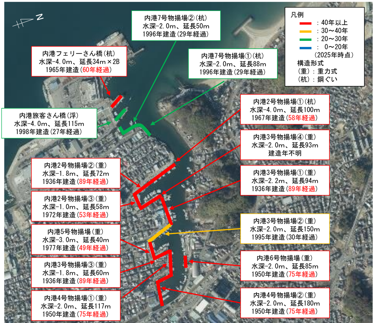
図 2.44 老朽化状況（内港地区）
