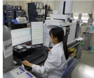
GC-MS/MSによる高精度残留農薬分析
