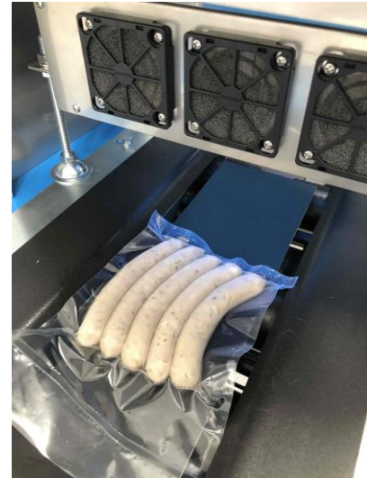
図1 UV-LED 照射デモ機の構成及び照射状況
