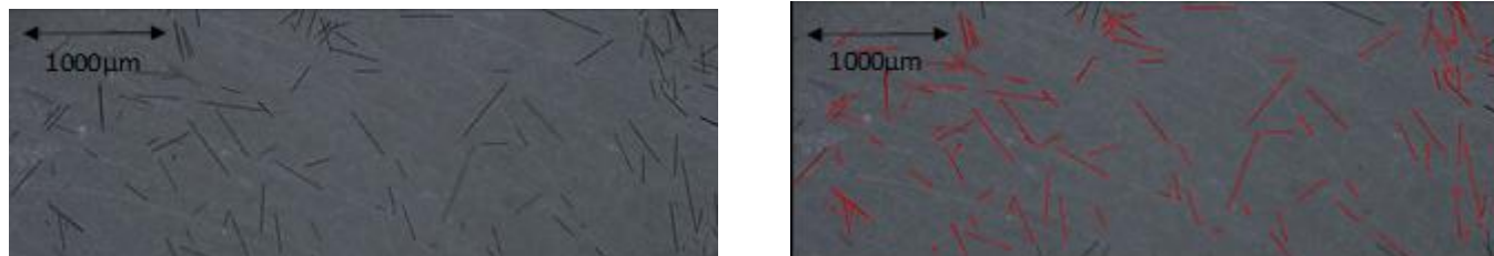
図2 マイクロスコップでの繊維長測定(rCF10mass% PLA)(左：測定前画像 右：測定後画像)
