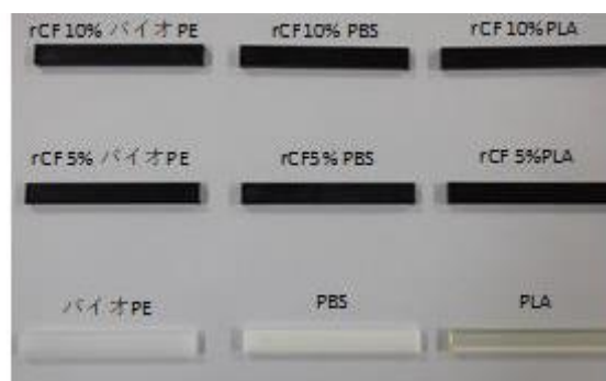
図3 射出成型機で成形した短冊試験片
