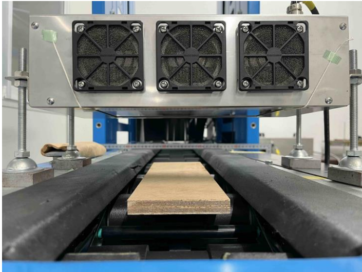
図1 UV-LED 照射デモ機の構成及び照射状況
