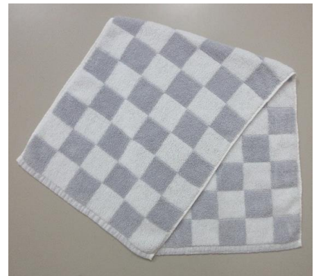
写真 5 spanボンド使用試作タオル
