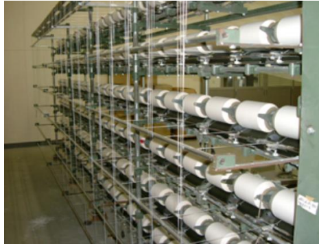
写真3 スリット加工のボビン巻き
