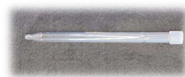
写真2 簡易検定手法に使用したパスツールピペットを加工した吸虫管
