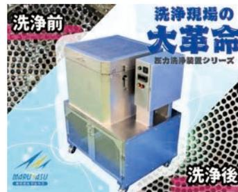
自社開発の洗浄液「ゲル・ピカラボ」と金型やノズルなどの金属部品用の洗浄装置を組み合わせた新しい洗浄方法を提案します。温度と圧力の作用により微細な隙間に入り込んだ樹脂が焦げも効果的に除去!簡単にキレイな洗浄が可能です。さらに焼く・擦る・削るなどの従来の洗浄方法と比較して、金属部品に傷をつけず、劣化も防ぎ、異物混入を顕著に減らせるため、生産性と品質が大幅に向上します。部品の形状やサイズに応じた洗浄装置を取り揃え、特注品対応も可能です。
