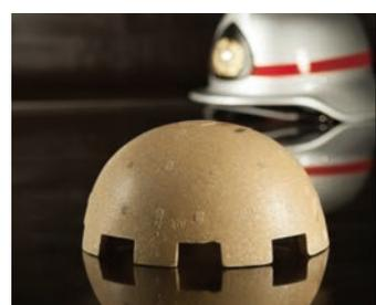
軽くて断熱性があり、水にも強い発泡スチロールに、“燃えない”機能を付加した超高温難燃性の新素材「バリシールド」。グラスウールと同等の断熱性能を有するとともに、UL94 5VA相当の不燃性があり、鉄道車両用材料燃焼試験でも不燃性の判定を受けております。また、製造工程でフロンは一切使用していないため、燃焼してもダイオキシンは発生せず、ホルムアルデヒド発散建築材料F☆☆☆☆を取得している環境配慮型製品で、密度40kg/m<sup>3</sup>と非常に軽いため、建築物の軽量化・作業負荷の軽減に繋がる製品となっています。
