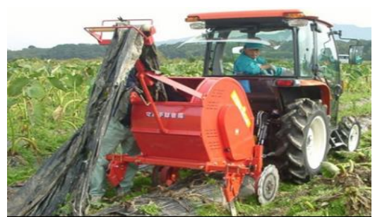
マルチ除去作業
