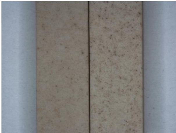
写真1 sk8還元焼成曲げ強度試験体 (左：実機試作坏土1、右：実機試作坏土2)
