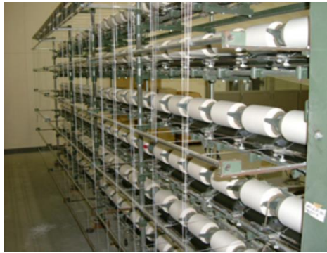
写真3 スリット加工のボビン巻き
