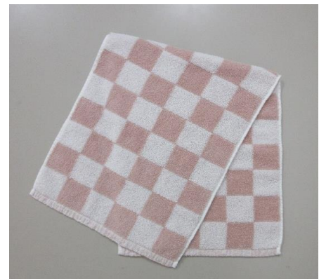
写真 6 サーマルボンド使用試作タオル
