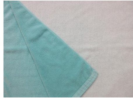
写真7 スパンボンド使用試作タオル
