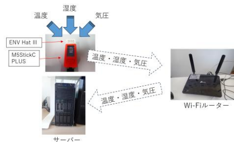
図1 温湿度・気圧データの取得方法
