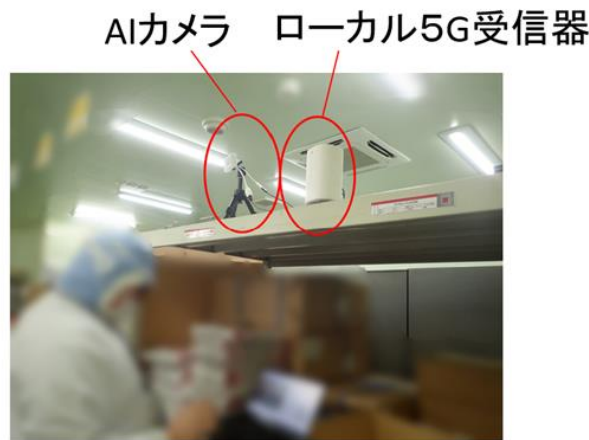
写真2 工場AへのAIカメラ設置状況
