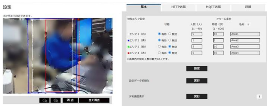
図3 AIカメラのバウンディングボックスの設定画面
