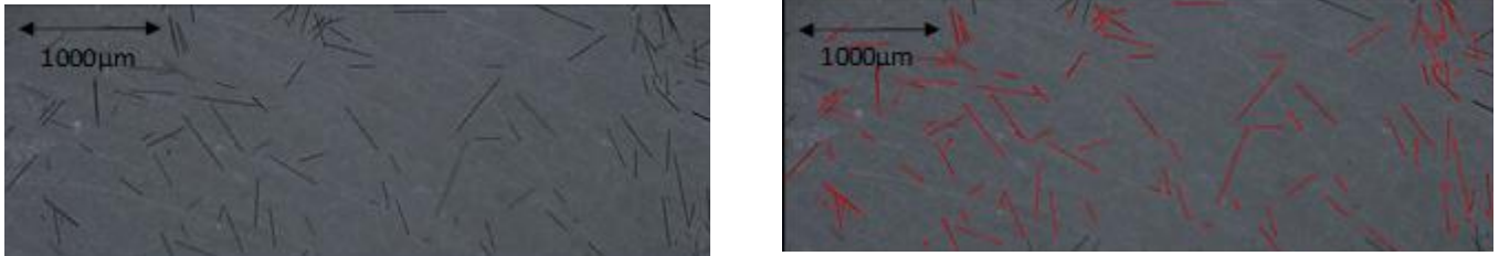
図2 マイクロスコープでの繊維長測定(rCF10mass% PLA)(左：測定前画像 右：測定後画像)
