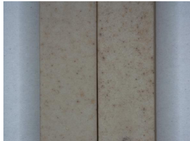
写真2 sk9還元焼成曲げ強度試験体 (左：実機試作坏土1、右：実機試作坏土2)
