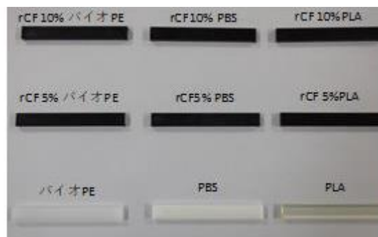
図3 射出成型機で成形した短冊試験片
