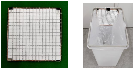
写真1 紙の設置状況 （左：金網に挟んだシート 右：ゴミ箱内での固定状況）
