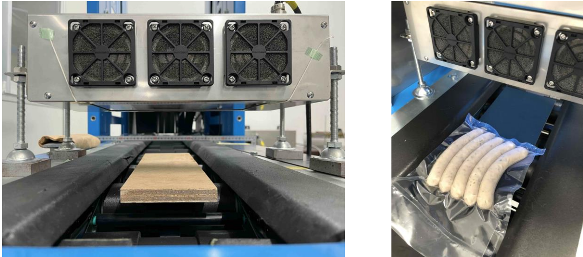
図1 UV-LED 照射デモ機の構成及び照射状況
