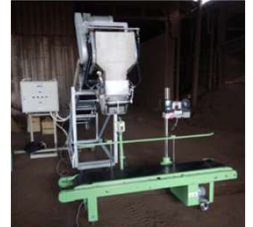
堆肥投入ホッパー及び 堆肥搬送計量装置
