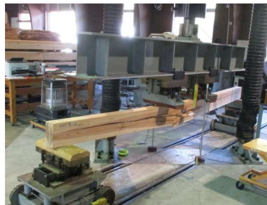
大径材を活用した試作品の載荷試験状況
