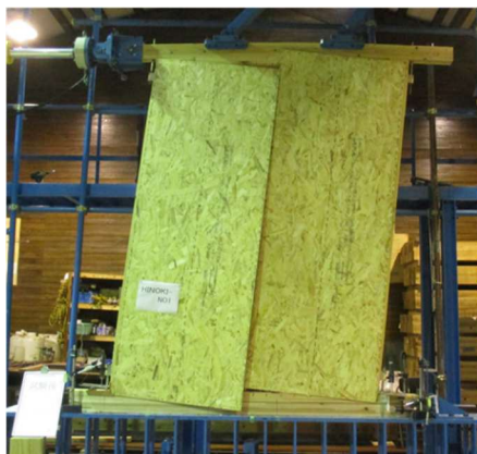
ツーバイフォー壁パネルの載荷試験状況
