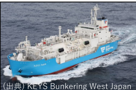
LNG燃料船へのバンキング船 (出典) KEYS Bunkering West Japan
