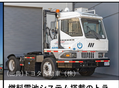
燃料電池システム搭載のトラックターヘッド (出典)トヨタ自動車(株)
