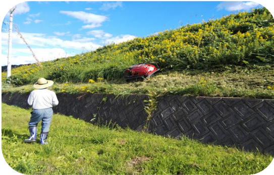
ラジコン草刈り機を用いたため池の草刈り（伊予市）
