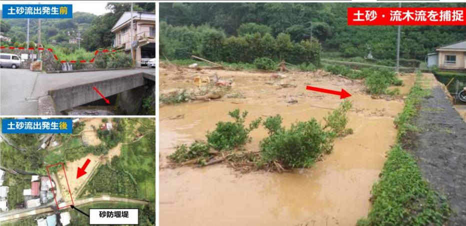
土砂流出発生前 / 土砂・流木流を捕捉 / 土砂流出発生後 / 砂防堰堤
