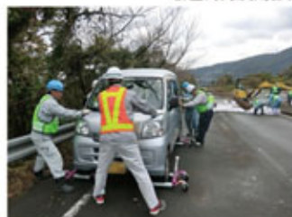
車両移動 (ゴージャッキ使用)
