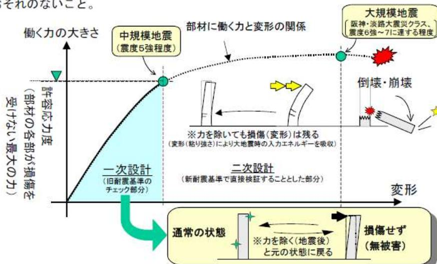
※ 二次設計には、保有水平耐力計算の他、より略率的な許容応力度等計算やより高度な構造計算方法である限界耐力計算等がある。
