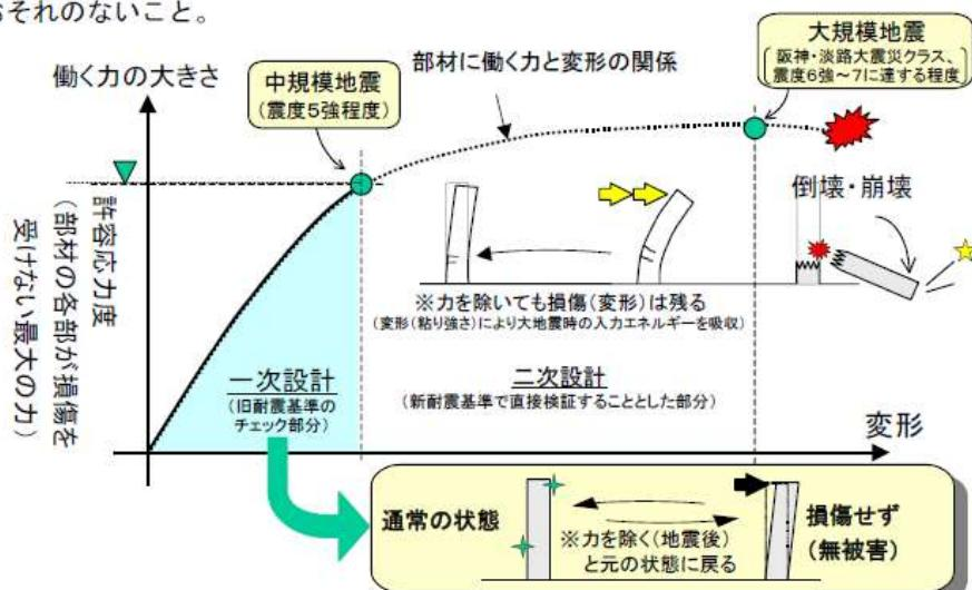
※ 二次設計には、保有水平耐力計算の他、より略算的な許容応力度等計算やより高度な構造計算方法である限界耐力計算等がある。
