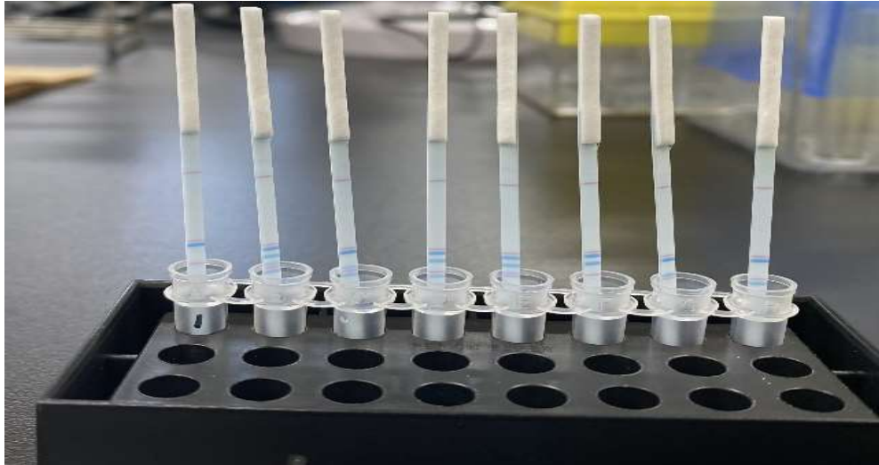
写真1 メンブレンスティックによる検出
