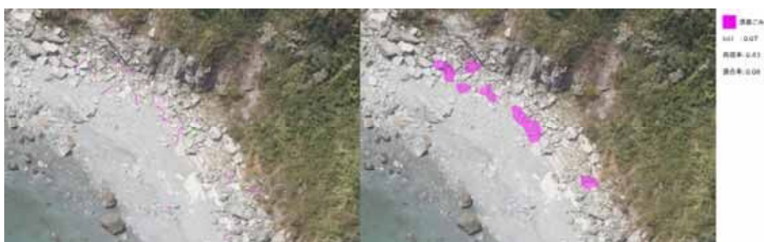
図 111-29 漂着ごみ検出モデルの検出結果 (左:正解(Ground Truth)、右:モデル検出結果)
