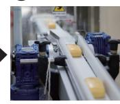
ペレット状に加工された石鹼素地を金型で成型。ここで出た端材は再利用される。
