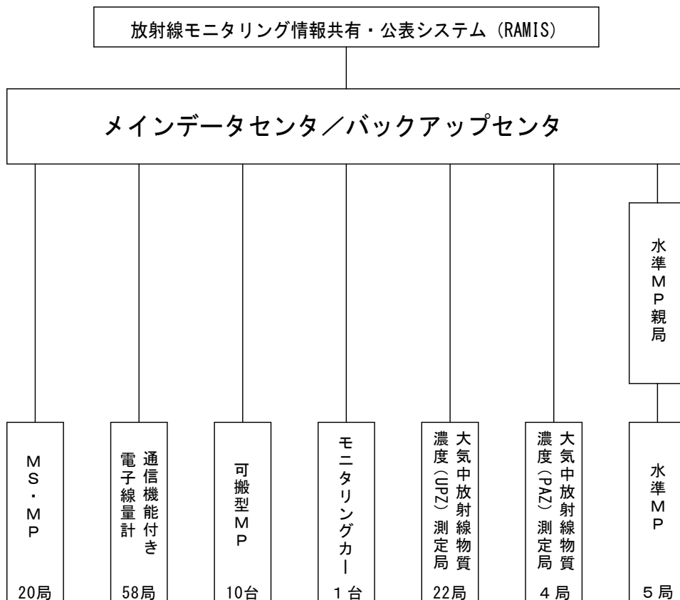
図2 新テレメータシステムの構成図
