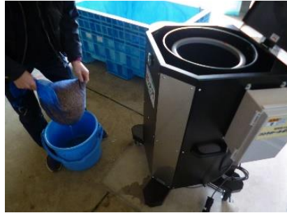
③脱水機（左：全体、中：糲の脱水、右：脱水後の糲）
