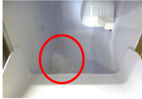
左：製氷機外観、右：機器内（赤枠：フレーク状の水）
