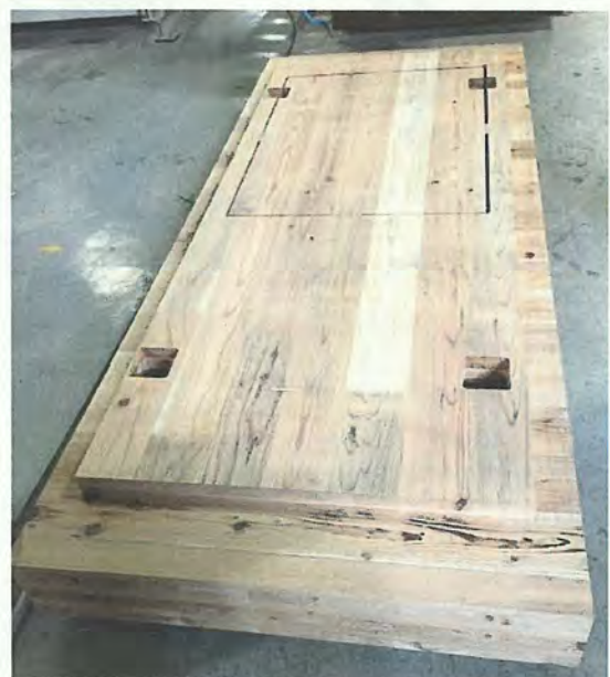
工場でカットされたCLT
