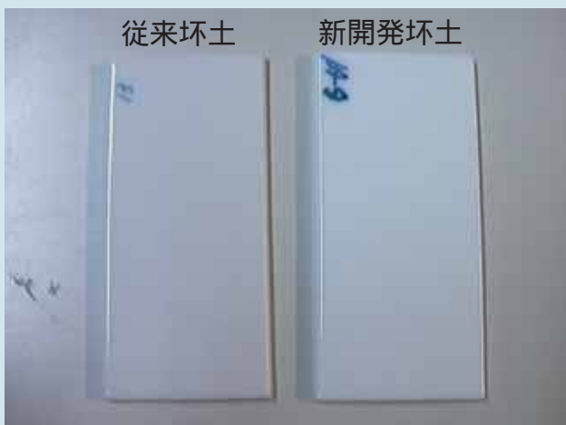
焼成試験体の白色度比較結果
